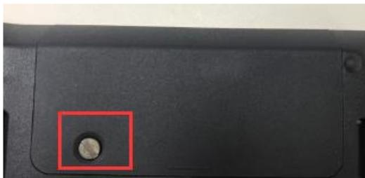
Снять крышку и вынуть батарею.
