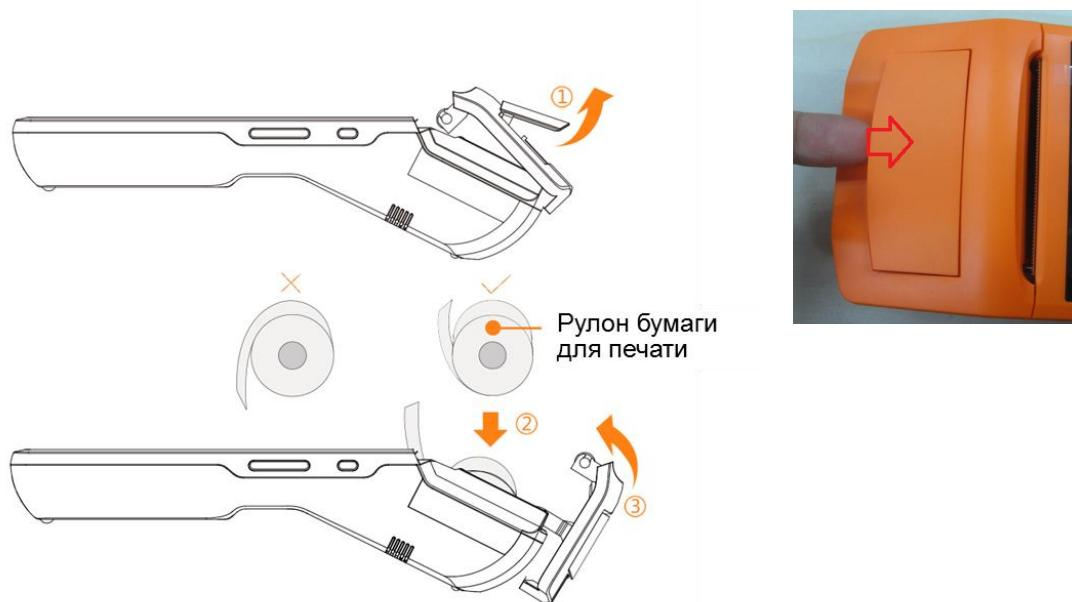
1. Крышка отсека принтера открывается с помощью ручки. Открытие крышки с применением усилия может повредить шестерни принтерной головки.
