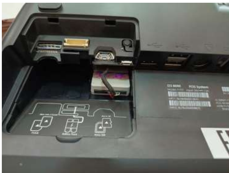
Фото 3. ФН, установленный внутри корпуса в аккумуляторном отсеке.
