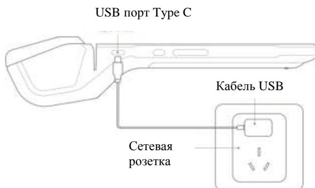
Аккумулятор можно заряжать с помощью адаптера, входящего в комплект. Аккумулятор можно заряжать от подставки, установив ККТ на подставку и подключив подставку к сети с помощью адаптера ККТ, входящего в комплект ККТ. Подставка в комплект ККТ не входит. При зарядке аккумуляторе на экране ККТ появляется иконка процесса зарядки.
