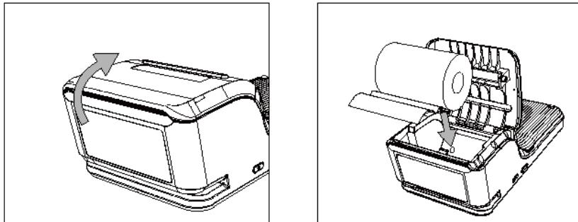
**Шаг 2:** Поместите рулон бумаги в ложемент принтера так, как показано на рисунке выше. Избегайте неверного положения рулона. Конец бумаги должен быть снизу, а активная сторона термобумаги должна касаться металлической пластины принтера (гребенки отрезчика). Вытяните немного бумаги, чтобы при закрытии крышки часть бумаги оказалась снаружи принтера.
